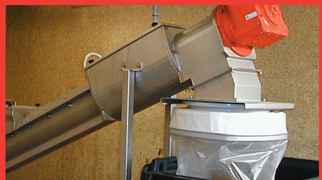
Udsnegling direkte i Longofil poser medfører optimale hygiejneforhold.
