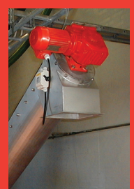
Sneglen drives af kvalitet snekkegear og motor fra SEW.
