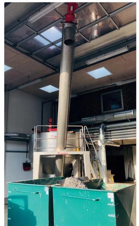
清洗过的砂石通过重力进行干燥，被直接输送至一个容器中，以备运输和重复利用。
