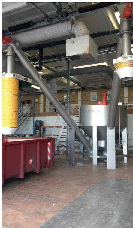
通过加装第二个螺旋输送装置，每台洗砂机的出砂量提高至每小时3吨。
