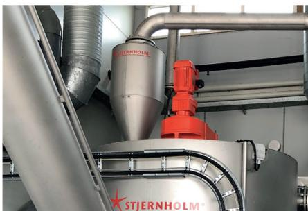
*Die Kapazität der Sandwaschanlage kann durch den Einbau eines Zyklons erhöht werden.*
