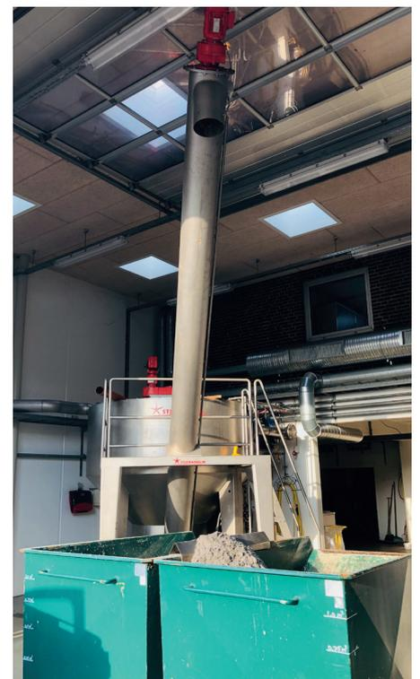
*Der gewaschene Sand ist komplett trocken und kann direkt in einen Container ausgetragen und abtransportiert oder wiederverwendet werden.*
