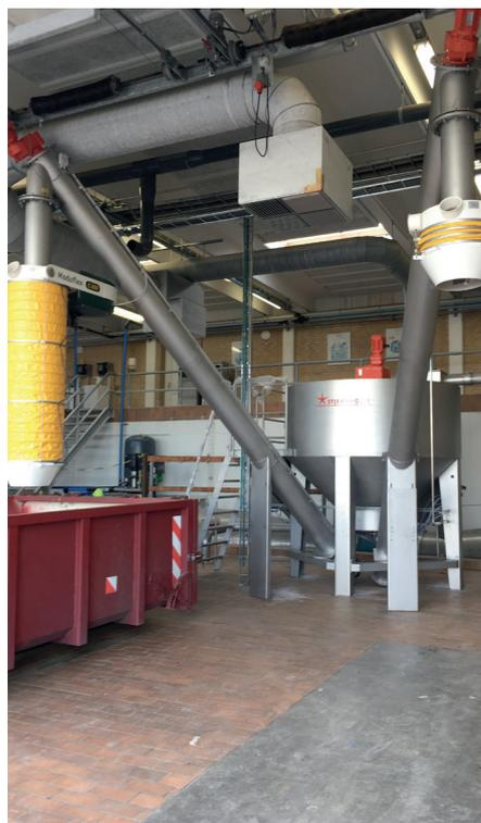
*Durch den Einbau einer zusätzlichen Förderschnecke kann die Kapazität auf 3t Sand pro Stunde erhöht werden.*
