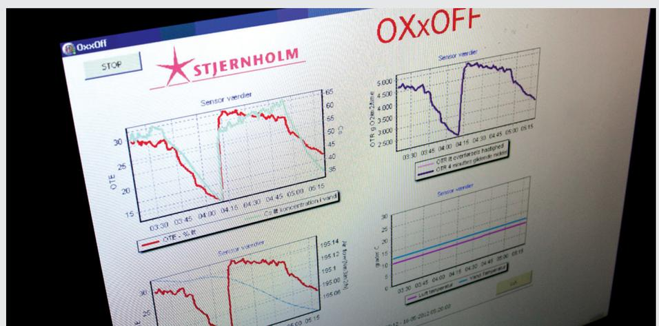
Die historischen Daten der Anlage werden in der Speicherkarte erfasst und können für die optimale Steuerung der Belüftung verwendet werden. Hierdurch lassen sich leicht Einsparungen von bis zu 25 % beim Energiebedarf für die Bodenbelüftung einsparen.
