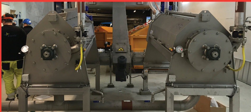
Anvendelse af AISI 316 stål giver høj beskyttelse mod korrosion og sikrer lang levetid, selv i forbindelse med spildevand.
