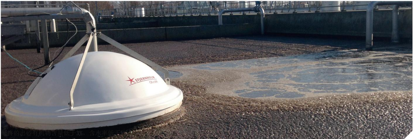
OXxOFF配备独特程序，可以采集以下即时数据：氧气传输效率(OTR)、标准氧气传输效率(SOTE)、氧气传输速率(OTR)和气流。
