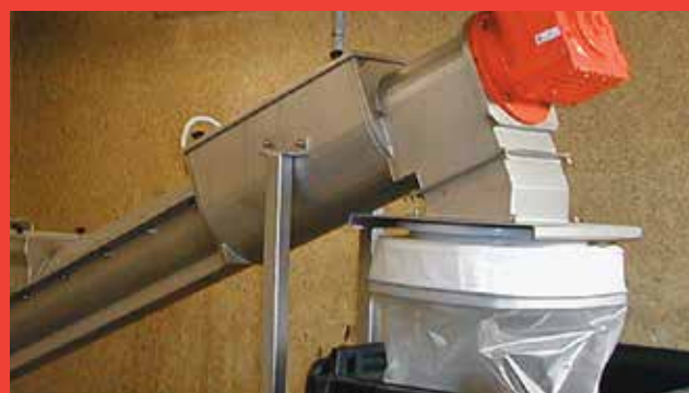
Udsnegling direkte i Longofil poser medfører optimale hygiejneforhold.
