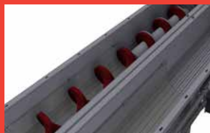
Snegletruget har for at minimere slidtage, indlagt et slidindlæg i HDPE eller PUR i forskellige godstykkelser, tilpasset til mediet og behov.
